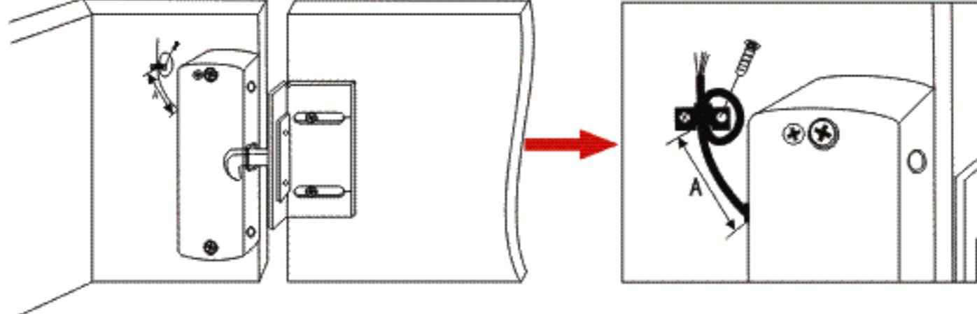
注：安装安毕后请将锁上的电子线按照图5所示固定起来，A点距离约为20CM.
